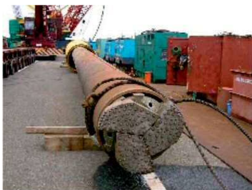
図 2.2.4-6 ダウンザホールハンマのイメージ
