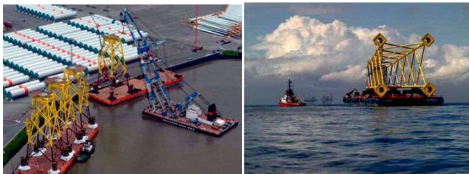
図 2. 2. 4-8 ジャケットの運搬状況のイメージ
