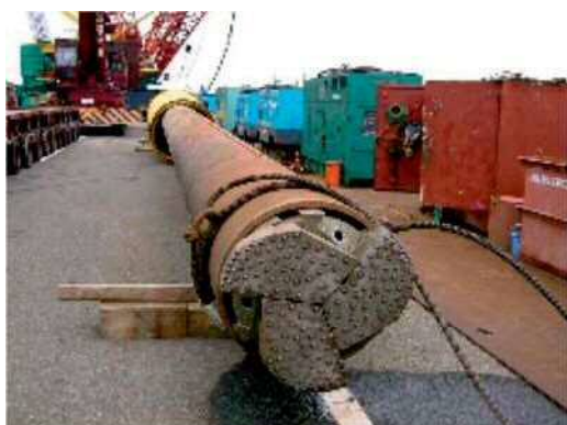
図 2.2.4-6 ダウンザホールハンマのイメージ
